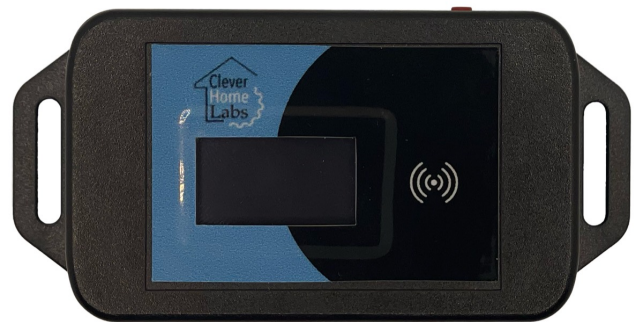
CDC mit OLED-Display, NFC-Bereich und Bedientaste
